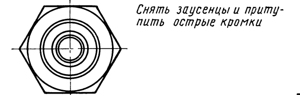
ЗАГЛУШКА КОРПУСА СОЕДИНИТЕЛЬНОЙ ГОЛОВКИ ГИДРОТОРМОЗОВ Сталь А12 ГОСТ 1414-54 холоднотянутая прутковая, шестигранник 36-а,34 ГОСТ 8560-57
